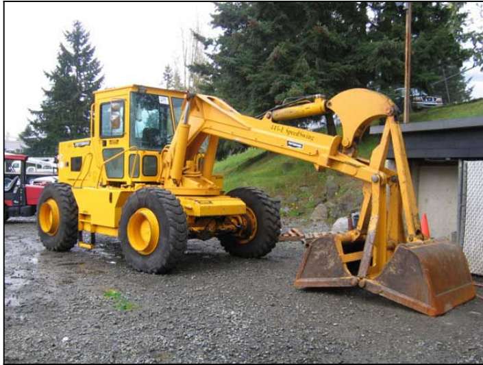
شکل (۲-۴۱) ماشینهای چنگک دار بدون مخزن
