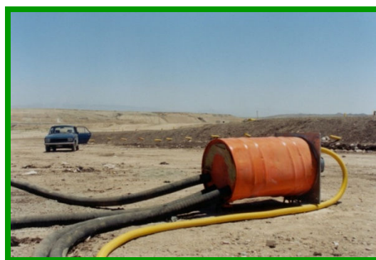
شکل (۸۶-۲) هوادهی توسط هواکش
