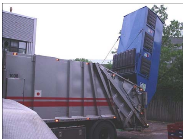
شکل (۲-۳۷) روش جمع آوری مخازن بزرگ در سیستم بارگیری از پشت
