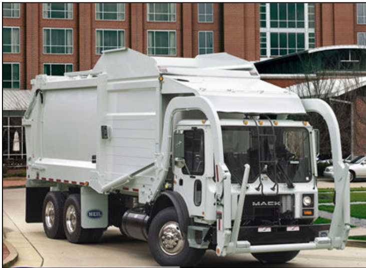
شکل (۲-۳۵) سیستم جمع آوری مکانیزه با بارگیری مکانیکی از جلو
