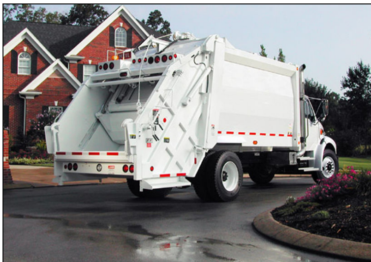
شکل (۲-۳۶) سیستم جمع آوری مکانیزه با بارگیری مکانیکی از پشت
