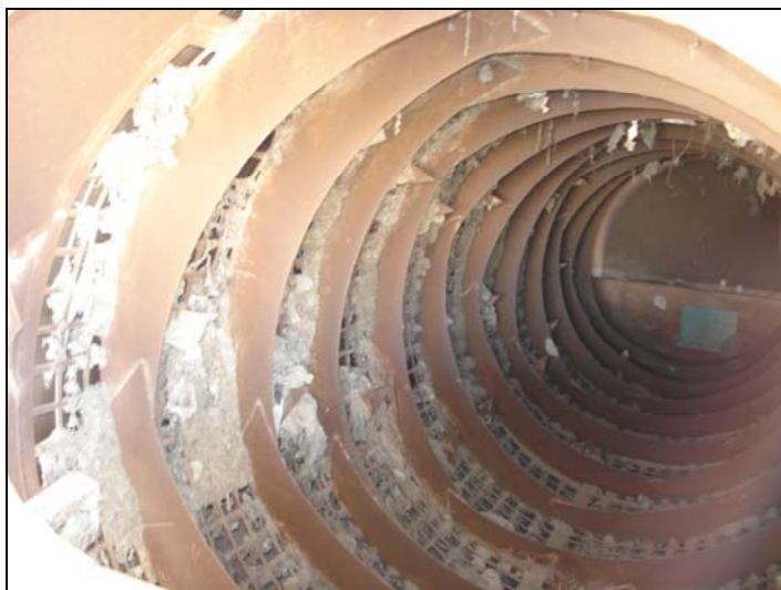
شکل (۲-۶۹) منظره داخلی یک شبکه بشکه ای
