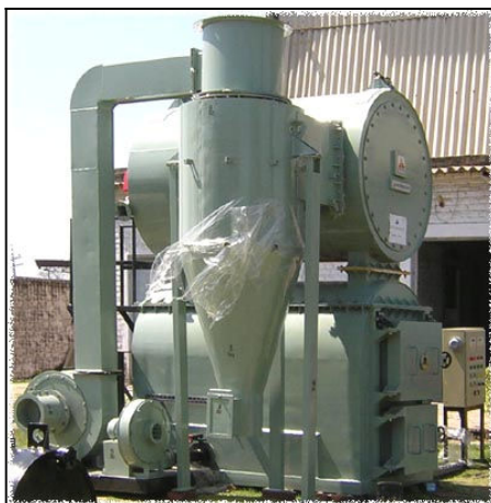
شکل (۲-۱۲۰) زباله سوز چند محفظه ای چرخشی برای زباله های پاتولوژیک
