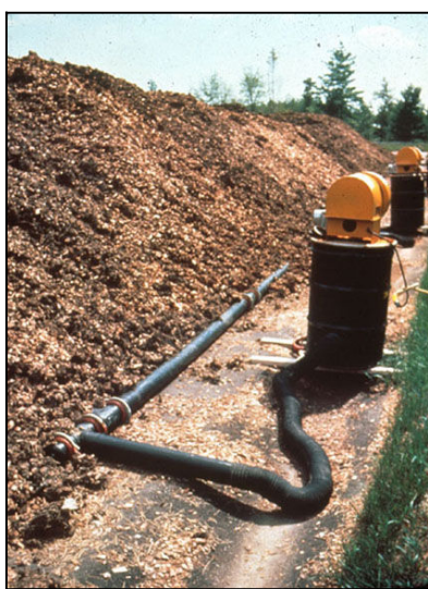
شکل (۲-۸۴) سیستم هوادهی در روش بیومکانیکال
