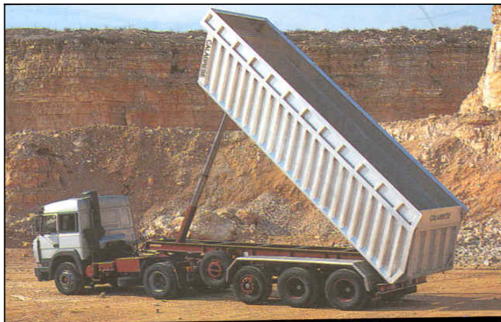
شکل (۲-۳۳) سیستم تریلر ویژه جمع آوری و انتقال پسماندهای جامد
