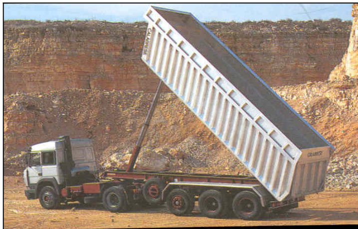
شکل (۲-۵۶) تریلرهای روباز مجهز به کمپرسی
