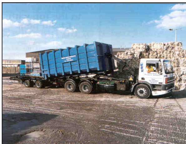
شکل (۳۲-۲) تجهیزات غلطان با بالابر قلابی ( HOOK LIFT )
