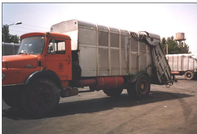
شکل (۵۰-۲) ماشین های روبسته جمع آوری و حمل پسماندهای جامد
