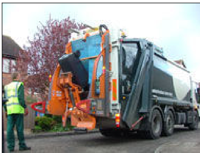
شکل (۲-۱۶) تخلیه مخازن مخصوص توسط هاپر با بارگیری از عقب
