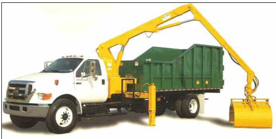
شکل (۲-۴۰) کامیونهای چنگک دار مجهز به مخزن
