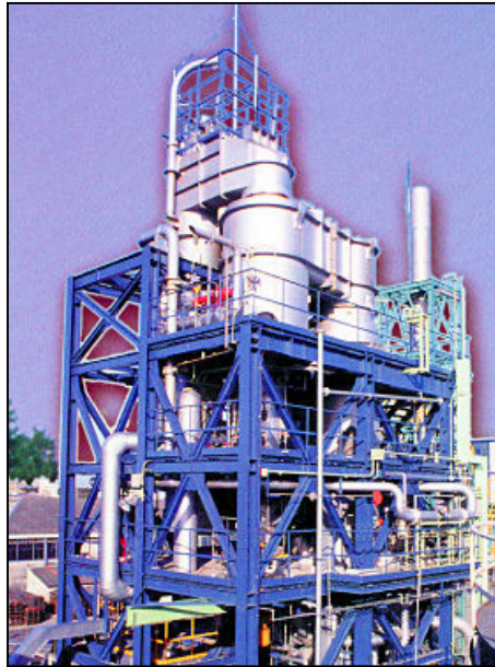
شکل (۲-۱۲۲) زباله سوز با بستر سیالی
