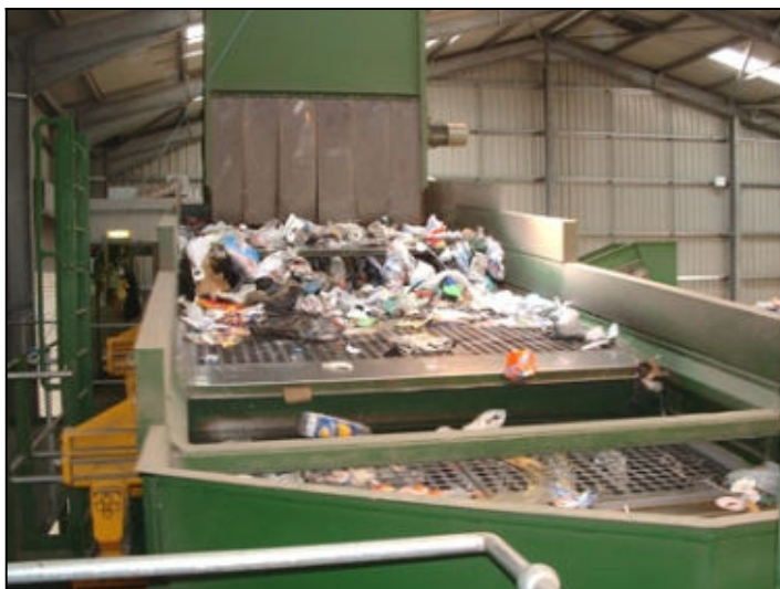
شکل (۷۰-۲) کاربرد غربالها در جداسازی مواد با اندازه های مختلف
