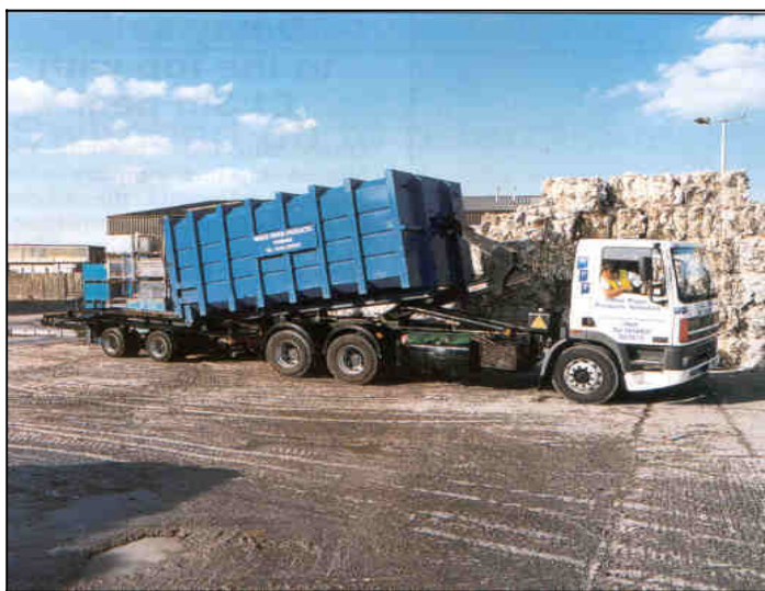
شکل (۲-۵۴) تریلرهای مجهز به کانتینرهای روبسته در ایستگاههای های مجهز به فشرده ساز
