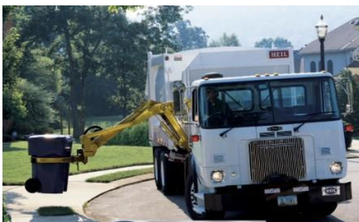
شکل (۲-۳۹) سیستم جمع آوری مکانیزه با بارگیری مکانیکی از کنار
