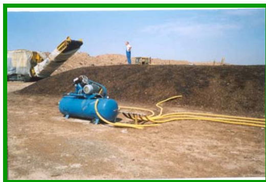
شکل (۸۷-۲) هوادهی توسط کمپرسور
