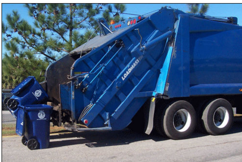
شکل (۱۲-۲) نحوه تخلیه مخازن چرخدار
