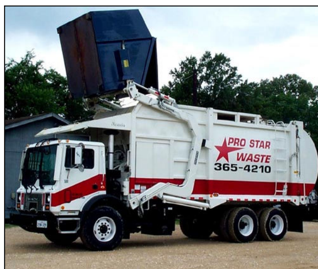
شکل (۲-۱۴) تخلیه مخازن مکانیزه با بارگیری از جلو
